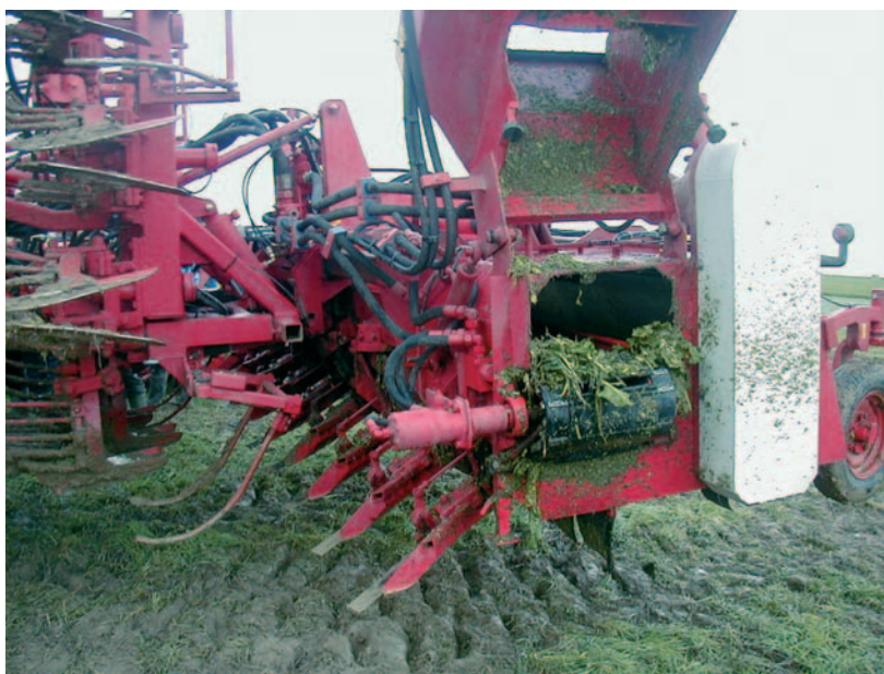
FIGURA 17. DESCARGA LATERAL DE HOJA EN UNA COSECHADORA PARA 6 FILAS
