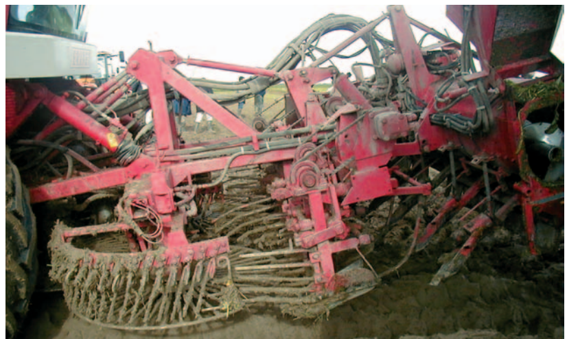
FIGURA 9. TURBINAS LIMPIADORAS QUE APROVECHAN LA FUGA CENTRÍFUGA
