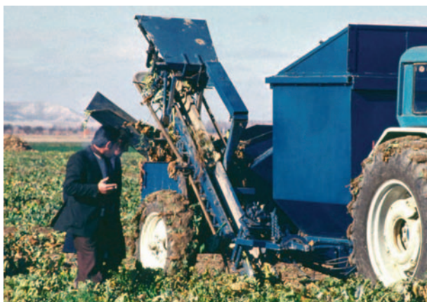
FIGURA 11. ARRANQUE POR TRACCIÓN
