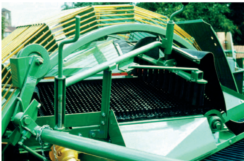
Elevador de cangilones al nivel superior.
