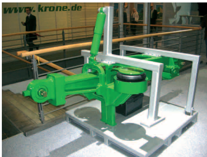
Nuevo sistema de suspensión neumática de las bandas de goma para tractores John Deere.
