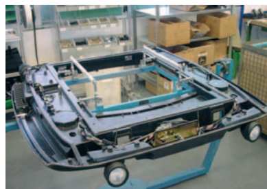
Techo interior en SMC para cabina tractor John Deere. Cortesía Elecqui.
