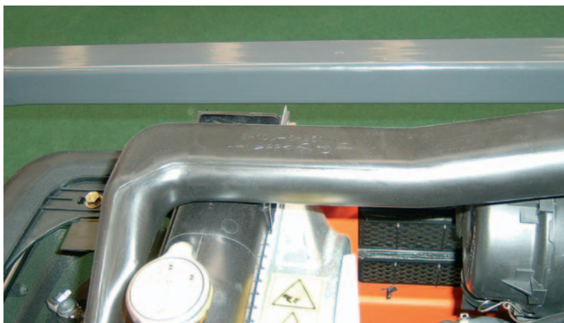
Conducto admisión en motor. Tractor Kubota realizado en PP.
