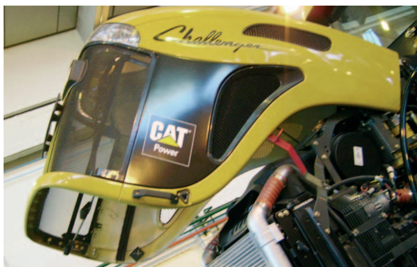
Capó tractor Challenger realizado en poliéster.
