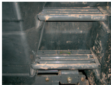
Escalera de acceso incrustada en el propio depósito de combustible.
