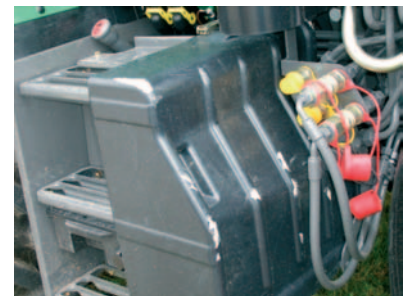
Tapa de batería realizada en poliéster. Bajo la escalera de acceso derecha está la caja de herramientas.
