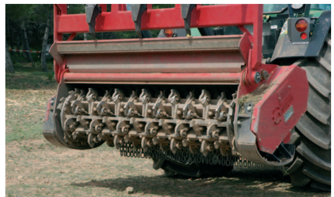
Desbrozadora - trituradora de púas fijas.
