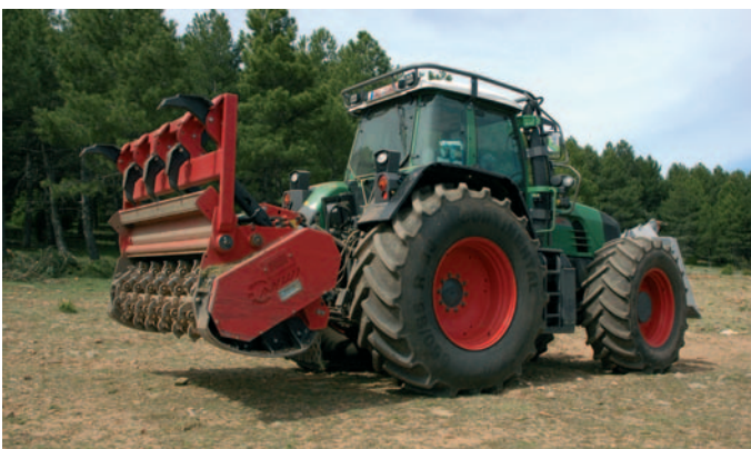
Desbrozadora - trituradora de púas fijas.
