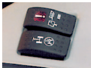
El conductor puede controlar el eje delantero suspendido QuadLink mediante un interruptor.
