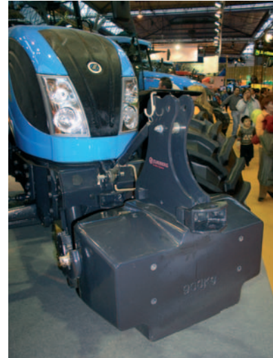
Un tractor Landini expuesto en la feria montó un contrapeso delantero de Zuidberg.
