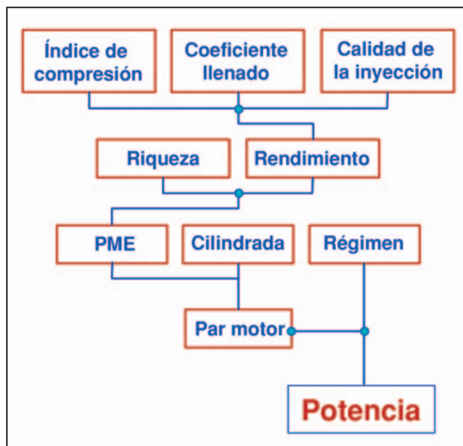
Figura 2.- Parámetros que determinan la potencia del motor
