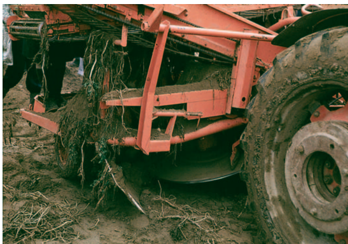
Sistema arrancador de reja fija y disco giratorio inclinado (a la derecha detalle del disco con su rascador).
