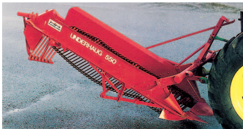
Arrancadora-hileradora de reja doble y transportador de cadena.
