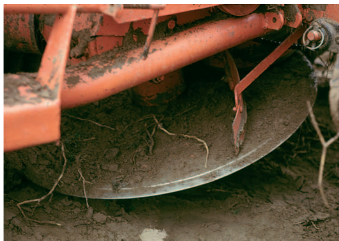
Sistema arrancador de reja fija y disco giratorio inclinado (a la derecha detalle del disco con su rascador).
