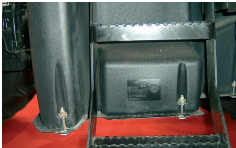
Depósito combustible tractor SAME con el marcaje correspondiente al tipo de plástico (PE) además de la referencia y código de fabricación de la pieza del fabricante
