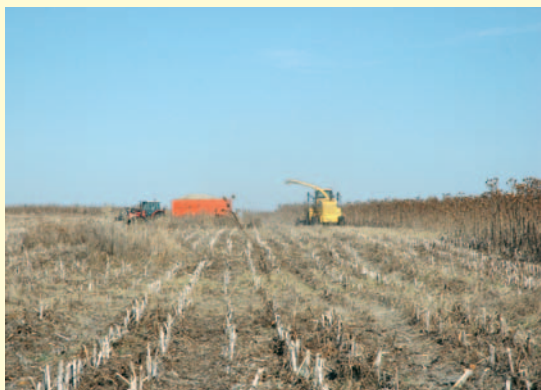
Recolección de la biomasa picada con la cosechadora de forraje New Holland FX 60 Hydroloc .
