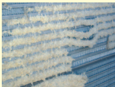
El cynara muy maduro produce gran cantidad de vilano, que tiende a obstruir las rejillas de las máquinas.
