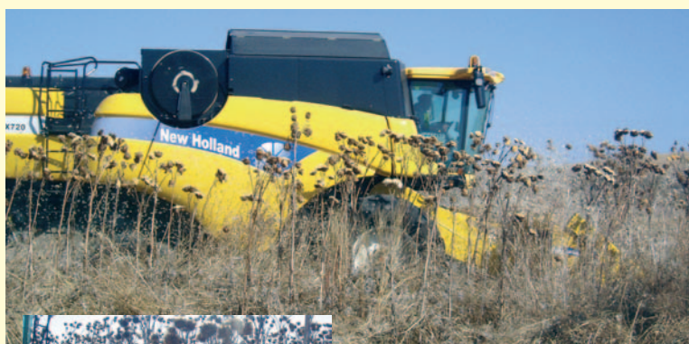
Recolección de la semilla y troceado de los tallos con la cosechadora New Holland CX 720 equipada con cabezal para maíz.
