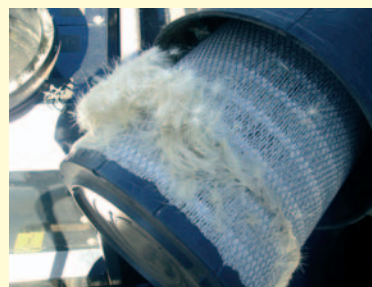
El cynara muy maduro produce gran cantidad de vilano, que tiende a obstruir las rejillas de las máquinas.
