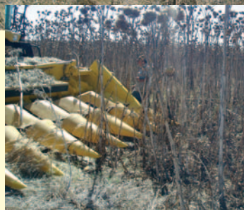
Recolección de la semilla y troceado de los tallos con la cosechadora New Holland CX 720 equipada con cabezal para maíz.
