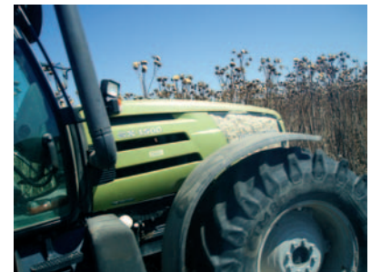
Acumulación del vilano en los respiraderos de uno de los tractores.
