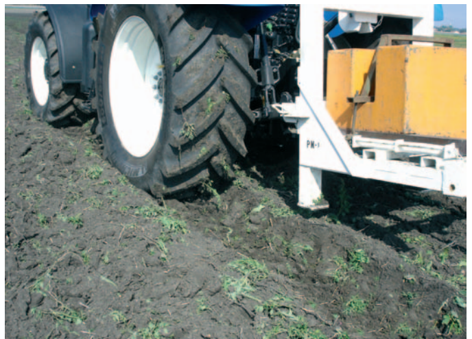
Ensayo en campo con sembradora y ensayo de tracción arrastrando otro tractor.
