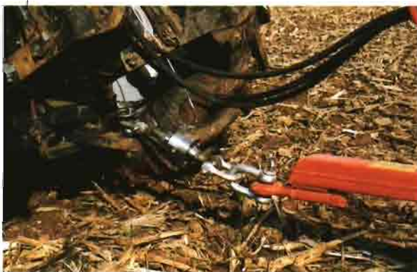
FIGURA 3.- Célula de carga instalada entre la 'barra tiro' del tractor y la lanza de la grada arrastrada.
