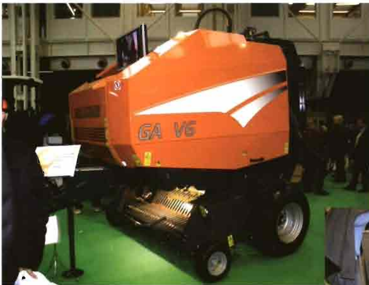
Roto-empacadora Gallignani con nuevo sistema para mejorar la homogeneidad de llenado de la cámara.
