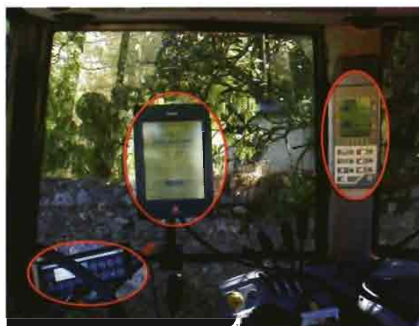
Sistemas Ferticontrol, Fieldstar y Datatronic 2, instalados en el tractor de ensayo.
