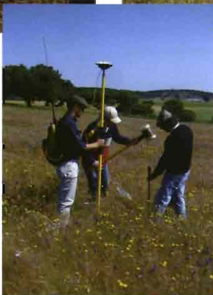
GPS con corrección diferencial Trimble RTK 4700: montado sobre tractor, en quad y en el campo.
