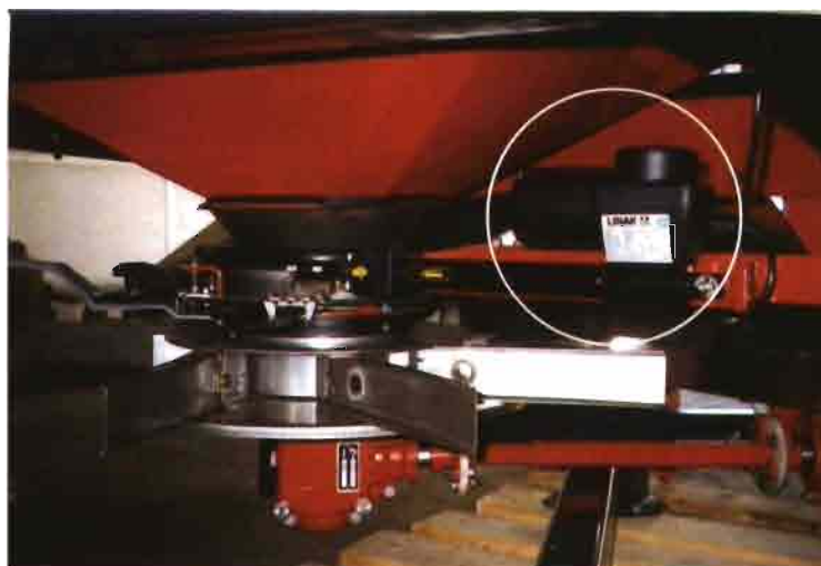
Actuadores eléctricos de apertura de los platos de dosificación del fertilizante.
