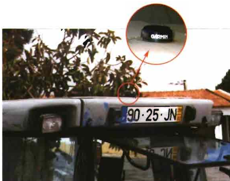
Antena GPS Garmin 16 montada sobre la cabina del tractor.
