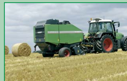
Rotoempacadoras de cámara fija y variable Empcadoras gigantes (pacas de 120 x 90, 120 x 70, 80 x 90)
