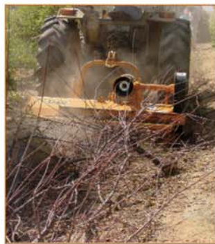
Trituradoras polivalentes con versiones reversibles.
