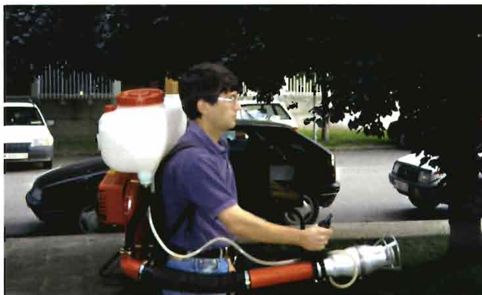
Equipo manual Micronair. Una corriente de aire mueve el cabezal centrífugo que forma las gotas, y posteriormente las transporta hacia el objetivo. Se emplea con notable éxito en España en tratamientos del olivar y contra langosta, entre otros (cortesía de Selvática).
