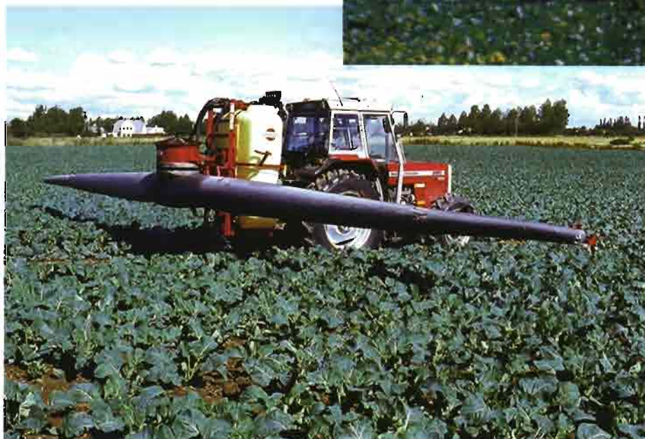
Pulverizador hidráulico de chorro transportado. Se emplea mucho en España en zonas en las que el viento reinante restringe mucho el tiempo disponible para las aplicaciones. Izquierda: sistema inactivo; abajo, activo.
