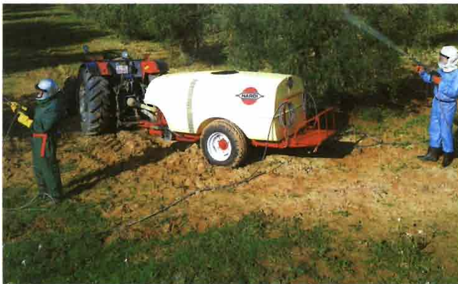
Los equipos con plataforma pueden trabajar sin interrupción en la calle con operarios sobre ella, si bien la foto muestra un trabajo a pie en borde de parcela.
