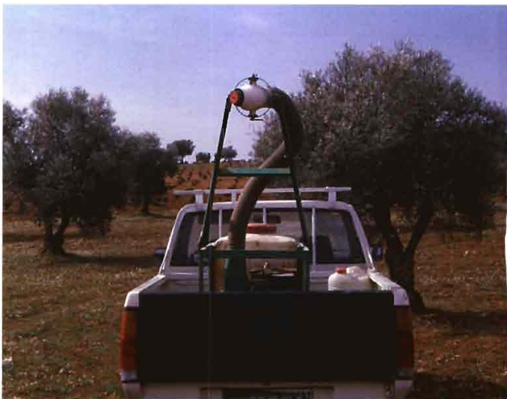
Equipo Micronair de Ultra Bajo Volumen empleado en los tratamientos del olivar. El conductor gobierna la apertura del circuito con un mando situado en el asiento del acompañante.
