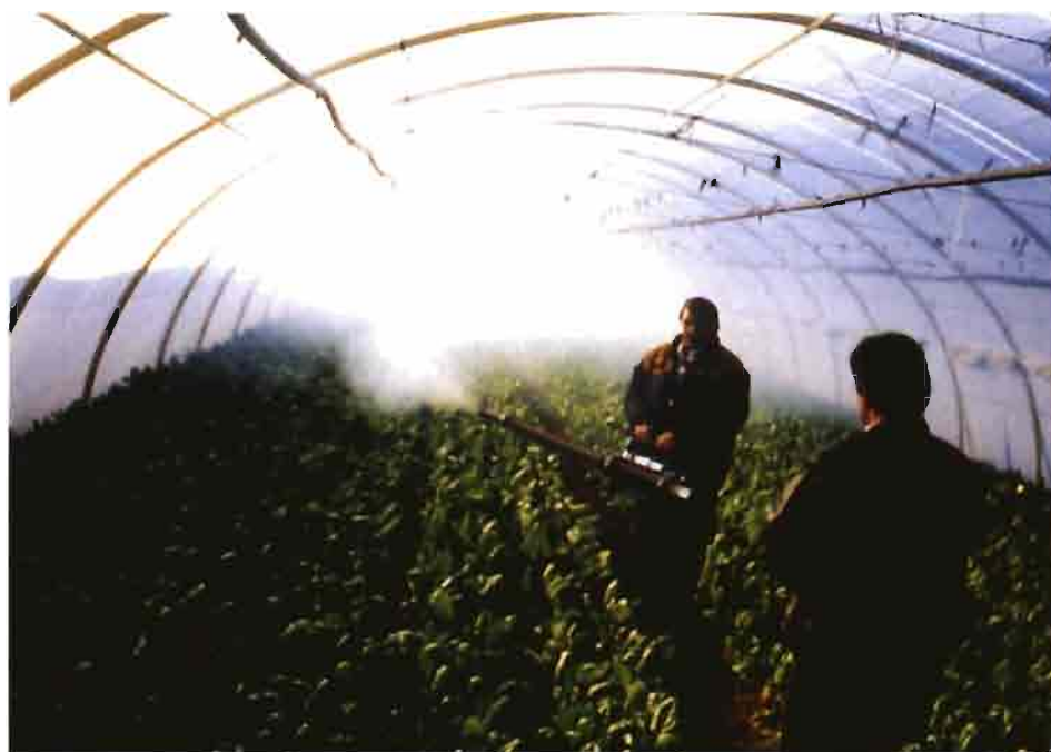
Fig. 3: Prueba de un termonebulizador en invernadero. (Villa del Pardo, Madrid). Tratamiento con agua como vehículo.
