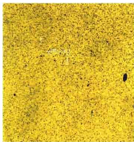
Fig. 4: Tarjeta hidrosensible obtenida en la prueba a que hace referencia la Fig. 3. La cobertura es muy alta, pero no es óptima pues el tratamiento se efectuó con temperatura ambiental alta.
