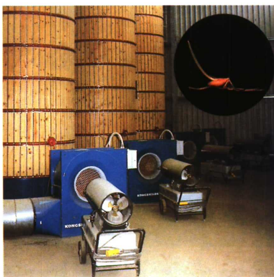
Secadores de descarga automática por flujo de aire radial, para instalación en nave.
