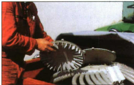
Detalle del distribuidor de aire + semilla.
