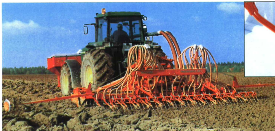
Sembradora neumática por corriente de aire.
