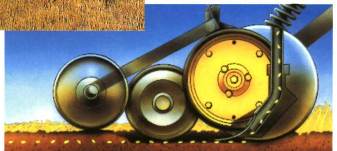
Disco simple inclinado respecto a la dirección de avance.
