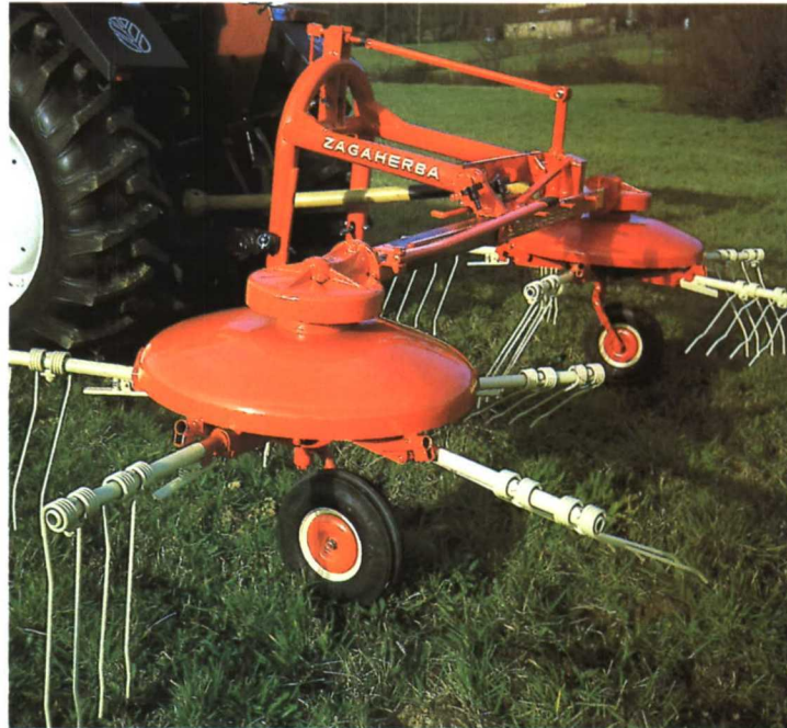
Rastrillo de doble rotor con eje vertical.
