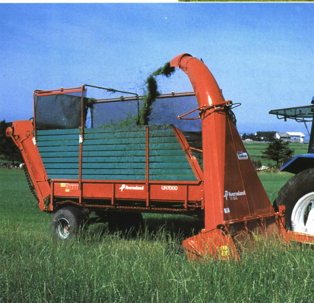
Tren segadora frontal-tractor-remolque: una opción para la recolección diaria de forraje verde. Puede ser manejado por un solo operario, a velocidad moderada.
