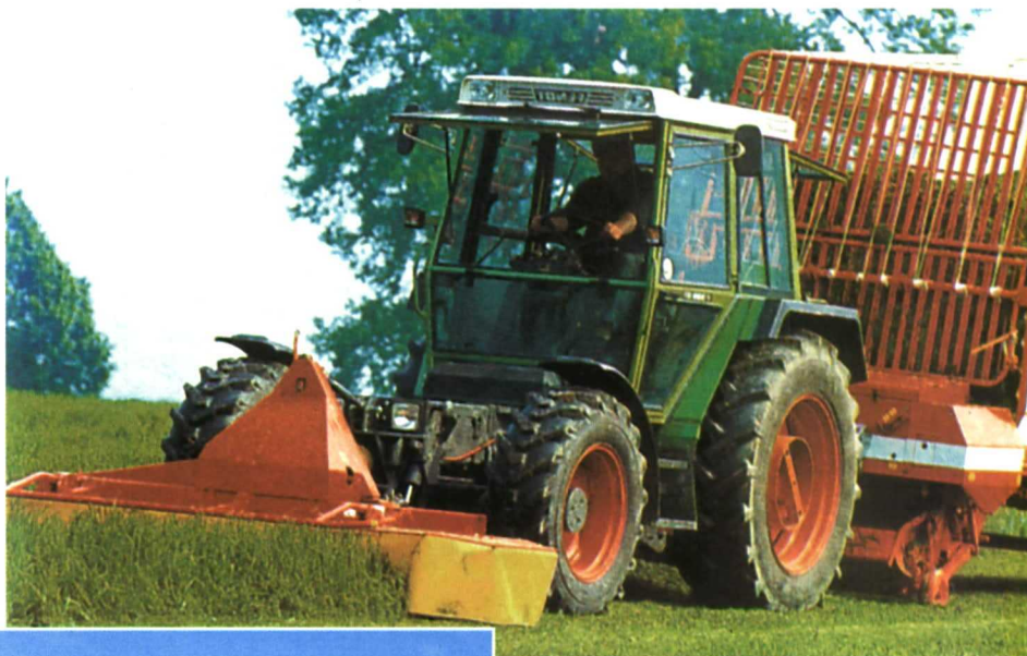
Tren segadora frontal-tractor-remolque: una opción para la recolección diaria de forraje verde. Puede ser manejado por un solo operario, a velocidad moderada.
