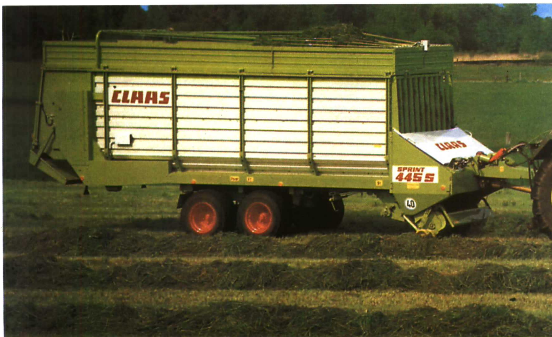
Remolque autocargador recogiendo forraje previamente hilerado, alineado con el tractor. Obsérvese el eje tándem que se adapta perfectamente al terreno, además de permitir realizar maniobras con mayor facilidad.
