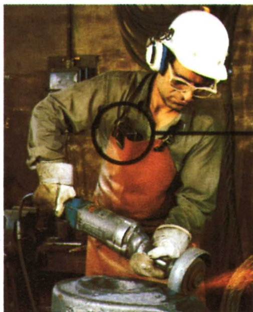
'Dosímetro' para medir la dosis de ruido recibida a lo largo de la jornada de trabajo.
