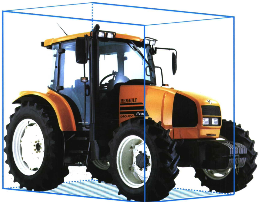
Un incremento de la potencia provoca el crecimiento del volumen del tractor según el cubo de una longitud mientras su apoyo lo hace sólo con relación al cuadrado de dicha longitud.
