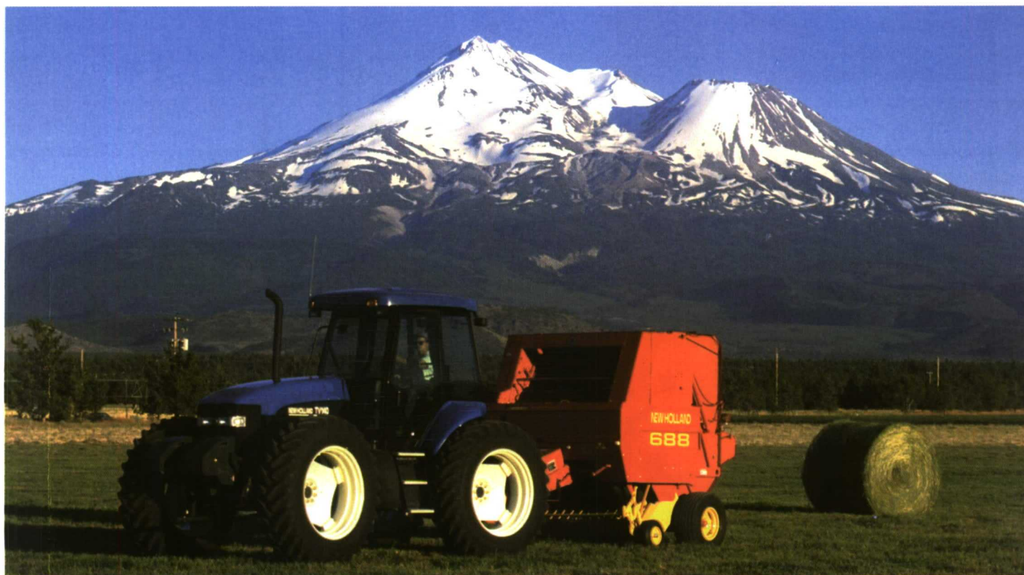
El aumento de la potencia del motor obliga a incrementar el diámetro de las ruedas motrices del eje delantero.
