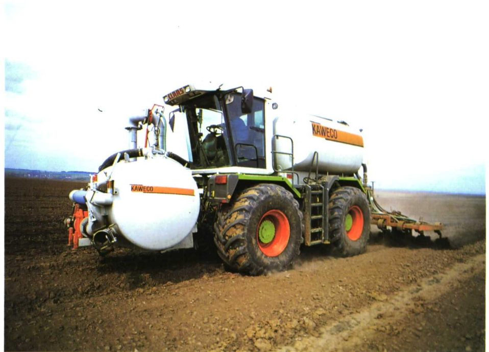
Con doble tracción total el límite de potencia está próximo a los 400 CV.
