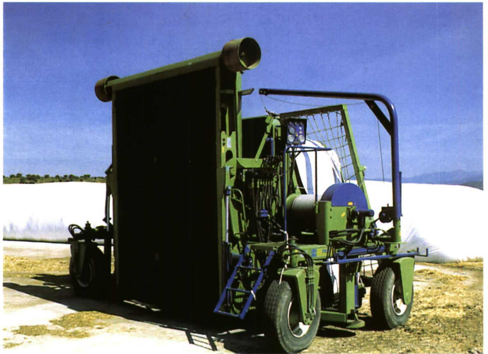
Parte anterior de la máquina en la que puede verse plegada la plataforma de entrega de las pacas al saco.
