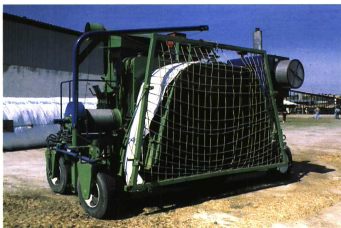
Parte posterior de la ensacadora, en la que se aprecian el saco colocado y una rejilla que se opone a la entrada de las pacas mediante un cable tensor, para conseguir, junto con el avance de la máquina, el estiramiento y la adherencia del saco a las pacas.
