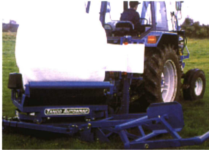
Envolvedora de plataforma giratoria (obsérvese la colocación del rollo de plástico respecto a la paca).
