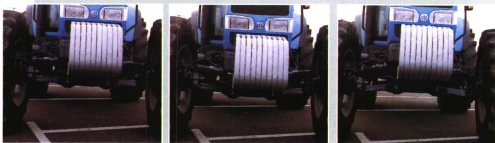
En las imágenes pueden observarse las tres posiciones que puede adoptar el eje delantero, en función de las necesidades del usuario.
