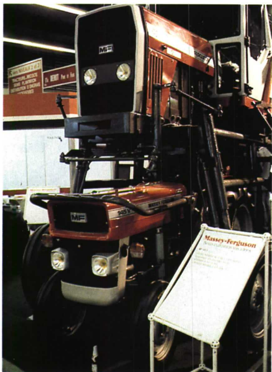
Dos alternativas para trabajar sobre la viña: zancudo y estrecho.
