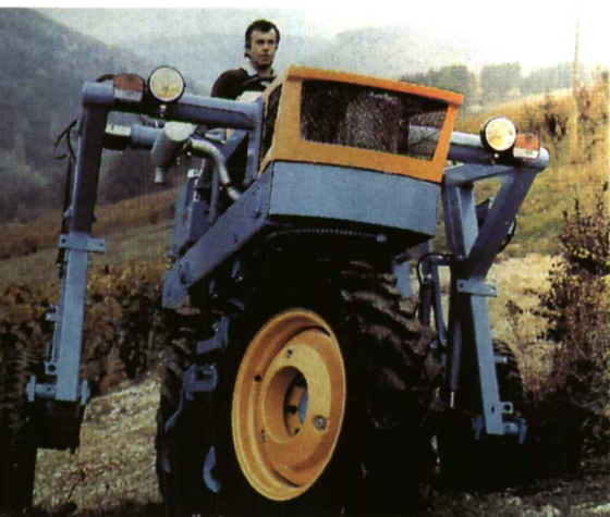
Tractor motociclo con apoyos laterales.
