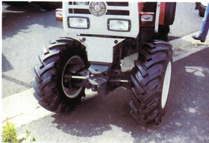
El diseño del eje delantero de los tractores estrechos difiere significativamente del de los tractores de tipo normal.
