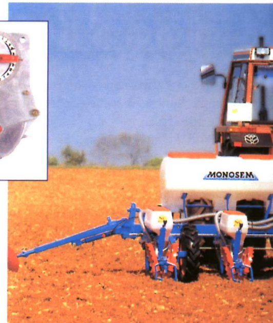
Dosificador neumático con cámara de vacío fija y plato giratorio.
