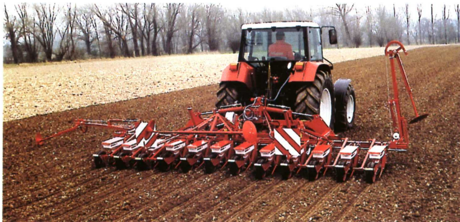
Cuerpo de siembra con dosificador mecánico para semilla pildorada de remolacha.
