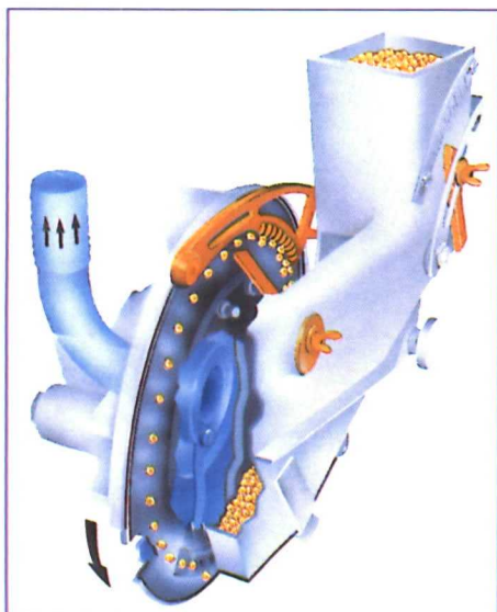
Dosificador neumático de Accord en el que el disco alveolado gira junto a la cámara de vacío.
