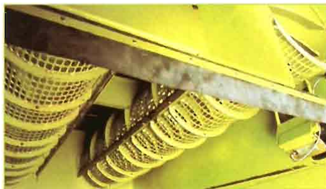
Sistema de trilla APS y separación Roto-plus de la cosechadora LEXION.
