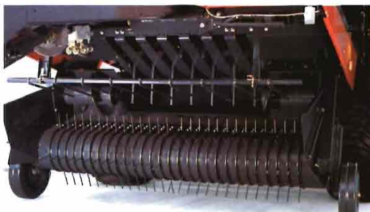
Recogedor de alto rendimiento que permite una anchura de recogida de 2.10 m.
