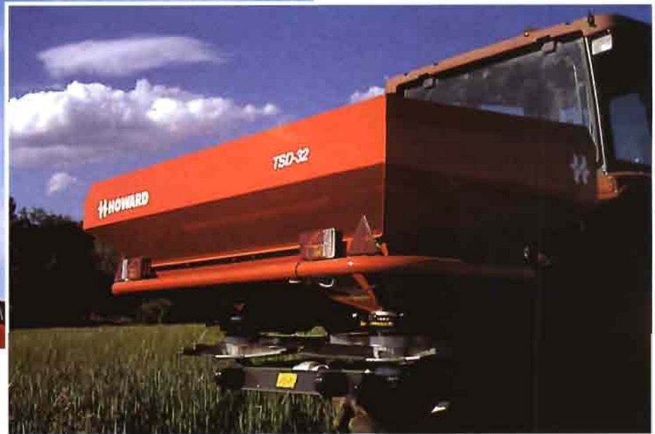
Abonadora de doble disco Howard TSD, con capacidad hasta 2 200 kg
