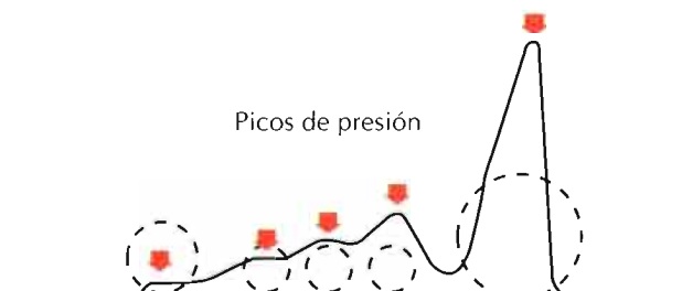
Presión real en el tractor de correas de goma sin apero
