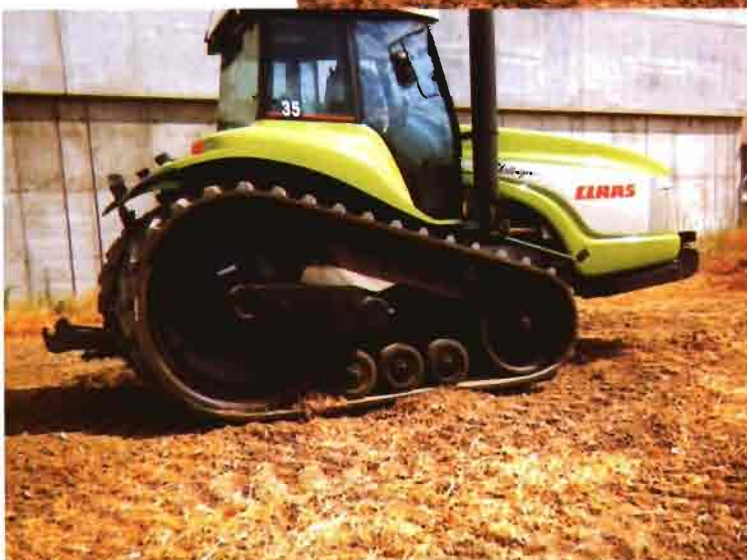
Figura 7.- Colocación de la tierra en la cadena en la demostración de autolimpieza.
