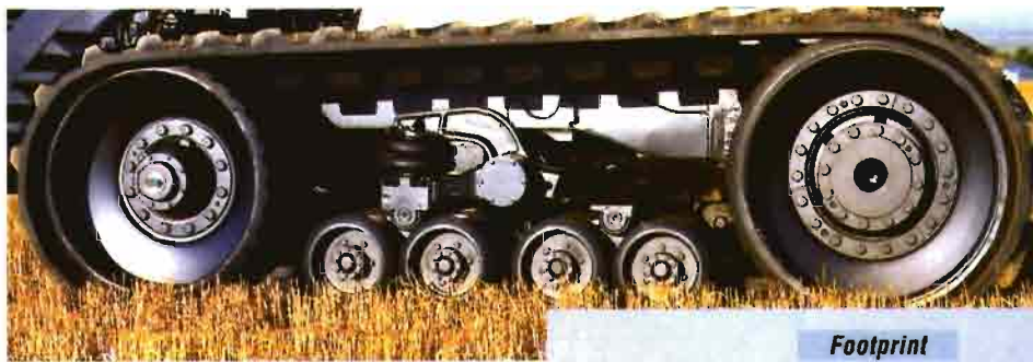
Figura 6.- Distribución del peso del tractor sobre los 6 puntos de apoyo.
