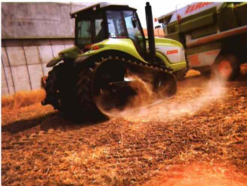
Figura 8.- Expulsión de la tierra por la parte superior de la cadena.
