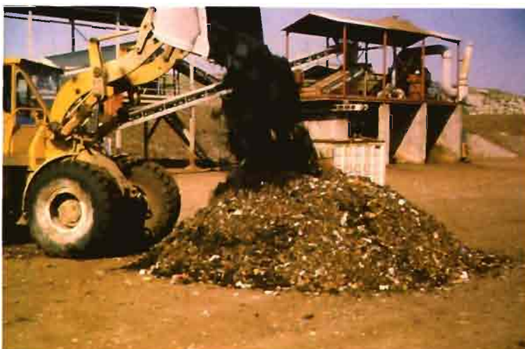
Preparación de una mezcla de lodos urbanos con la fracción orgánica de las basuras.
