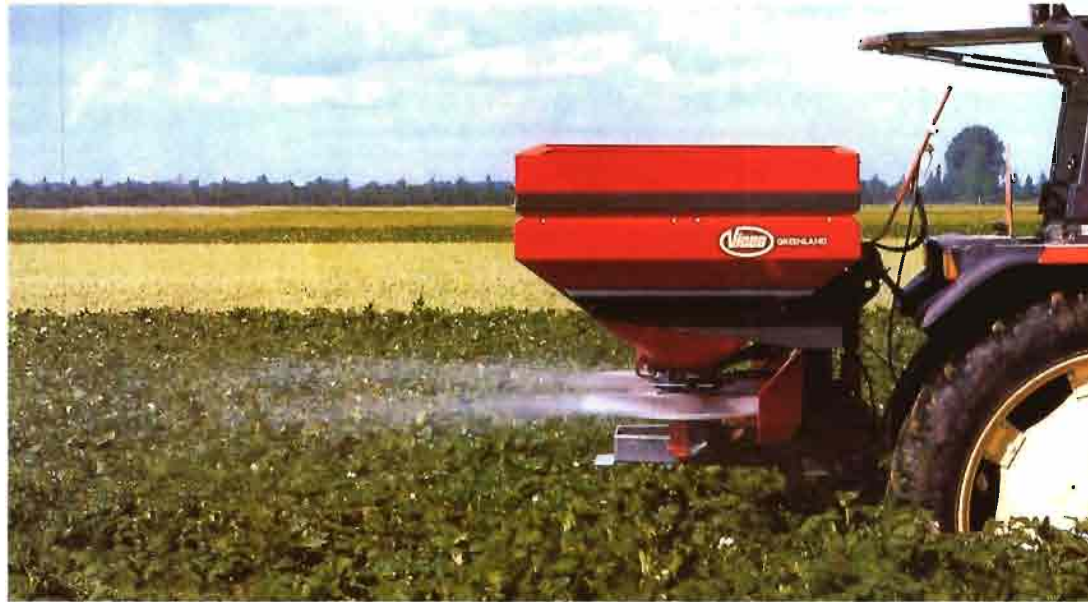
Este modelo presenta una mínima sensibilidad al viento debido a los discos planos.
