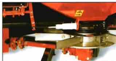
Fácil regulación de la dosis mediante ajustadores.
