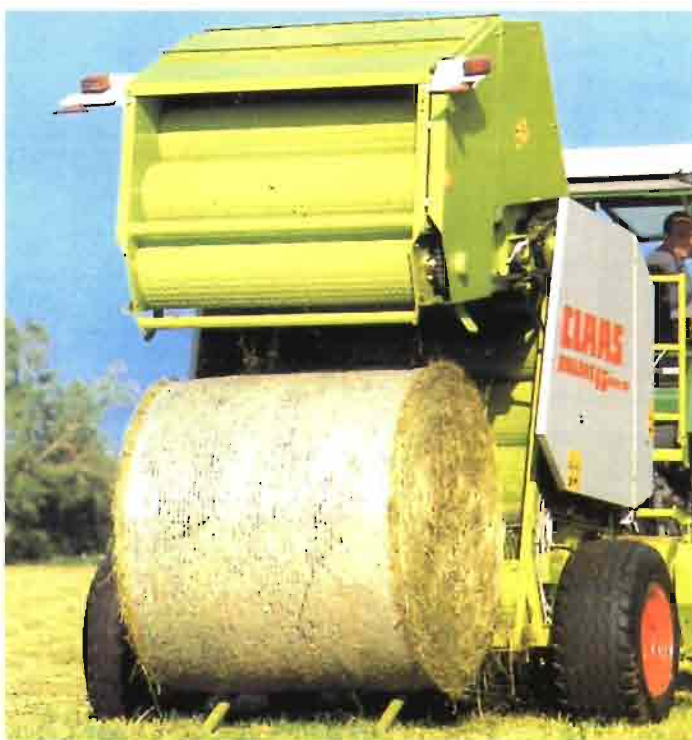
Rotoempacadoras de cámara fija. Arriba, esquema de funcionamiento; abajo, salida de una paca atada con red. Obsérvense los rodillos compresores dotados de salientes metálicos.
