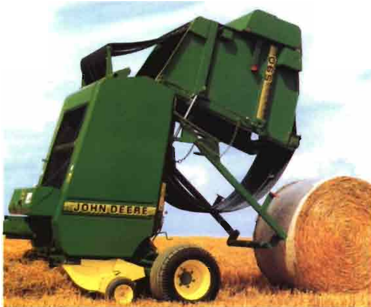
Rotoempacadora de cámara variable. Arriba, esquema de funcionamiento; abajo, salida de una paca atada con red. Obsérvense las correas que ejercen una presión continua sobre el producto a medida que se forma la paca.
