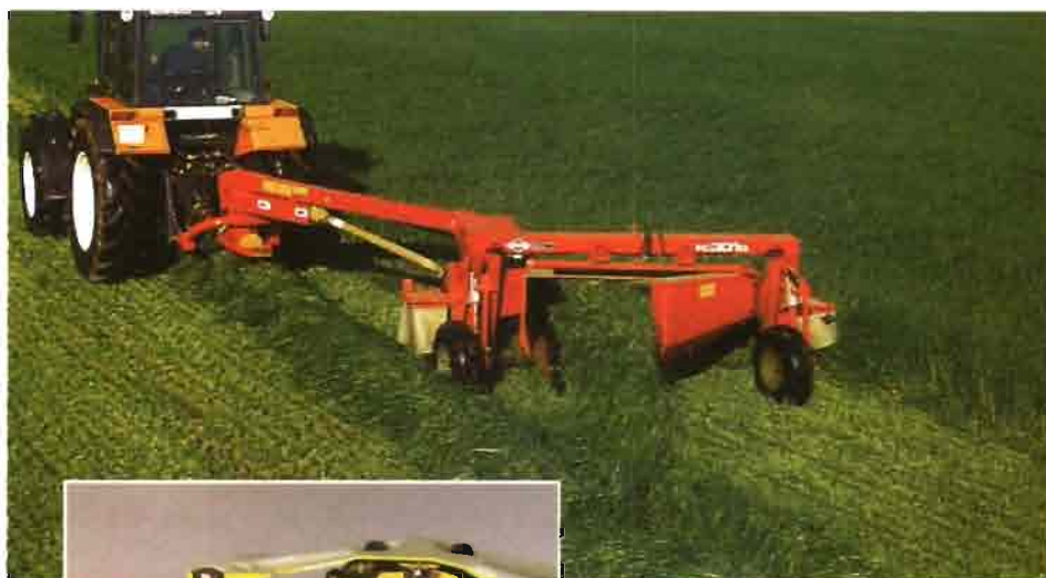
Barra de corte rotativas de Kuhn con posición simétrica del rodamiento respecto a la línea de esfuerzo.
