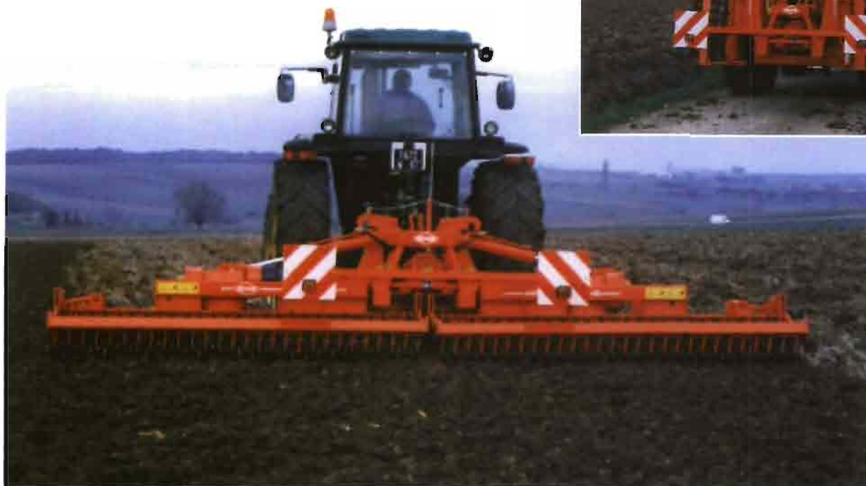
La nueva grada rotativa plegable HR 6002 D permite trabajar sobre una anchura de 6 m, siendo ésta en transporte de 2,50 m.
