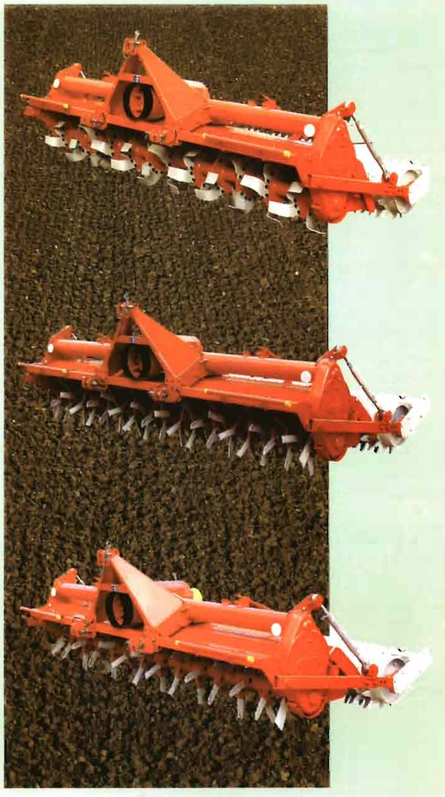
La polivalencia por el cambio de cuchillas permite a los rotocultivadores de Kuhn adaptarlos a diferentes tipos de trabajos.
