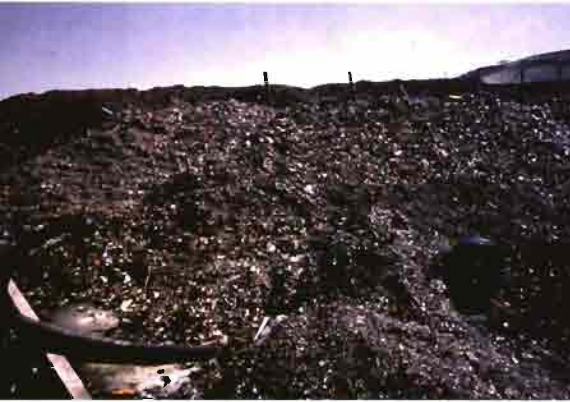
Panorámica de varias pilas de fermentación de la materia orgánica fresca de las basuras urbanas con un sistema de aireación forzada por medio de un ventilador.
