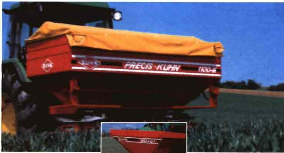
Abonadora de proyección con doble disco.
