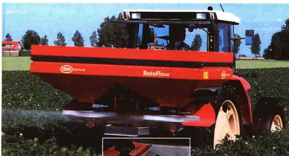
Modificando el punto de salida del abono se consigue buena uniformidad de distribución para la anchura de trabajo establecida.
