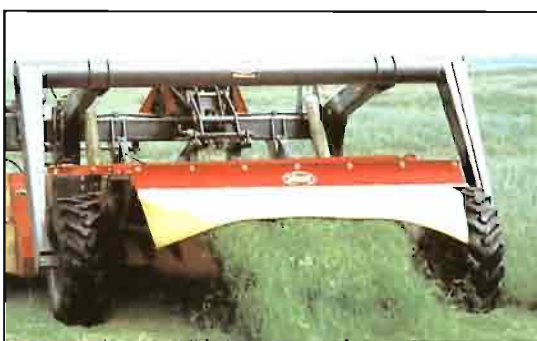
Segadora acondicionadora arrastrada de discos KMR 3200
