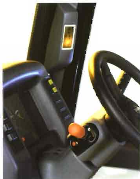
El 'joystick' tiene cuatro posiciones: adelante, atrás, neutral y parada.
