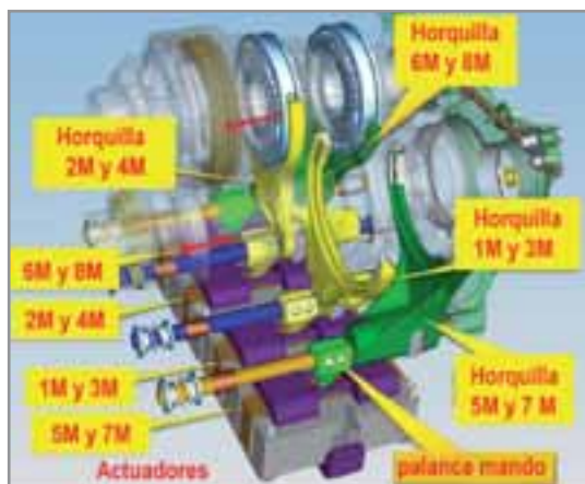
FIGURA 2.- ACTUADORES ELECTROMAGNÉTICOS EN EL MÓDULO 'DUAL-PATH'
