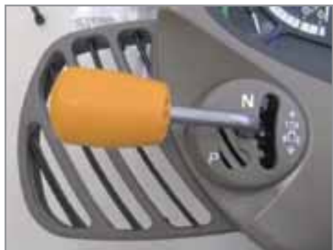
FIGURA 7.- CONTROL DEL INVERSOR CON NEUTRAL Y BLOQUEO
