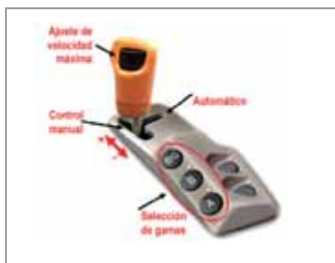
FIGURA 7.- CONTROL DEL INVERSOR CON NEUTRAL Y BLOQUEO
