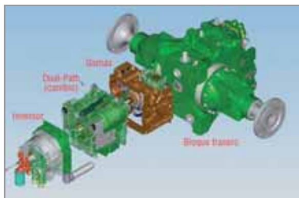
FIGURA 1.- MÓDULOS QUE COMPOEN LA TRANSMISIÓN DIRECTDRIVE
