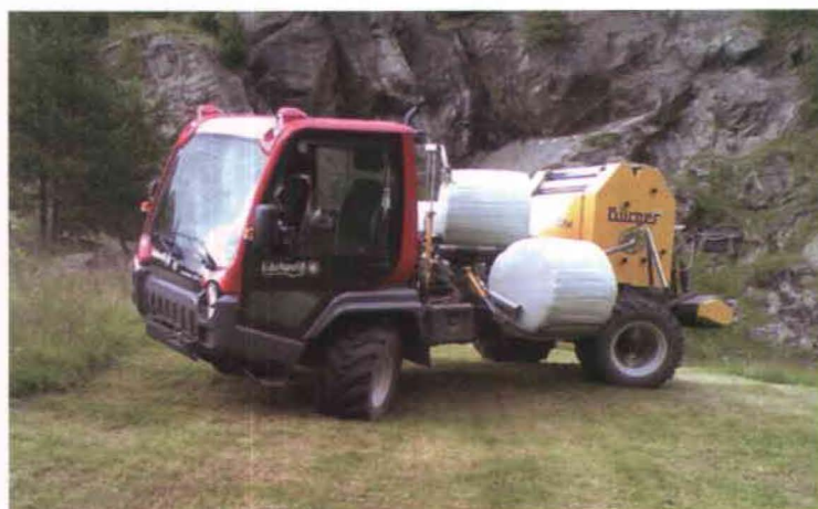
Figura 3.- Transportadora con rotoempacadora, envolvente y soporte para tres pacas.
