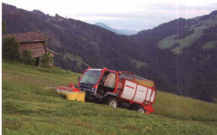
Figura 6.- Transportadora con segadora frontal y autocargador trasero
