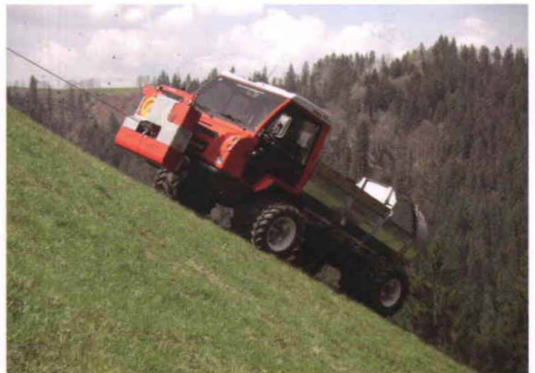
Figura 5.- Transportadora ascendiendo con el cablestante
