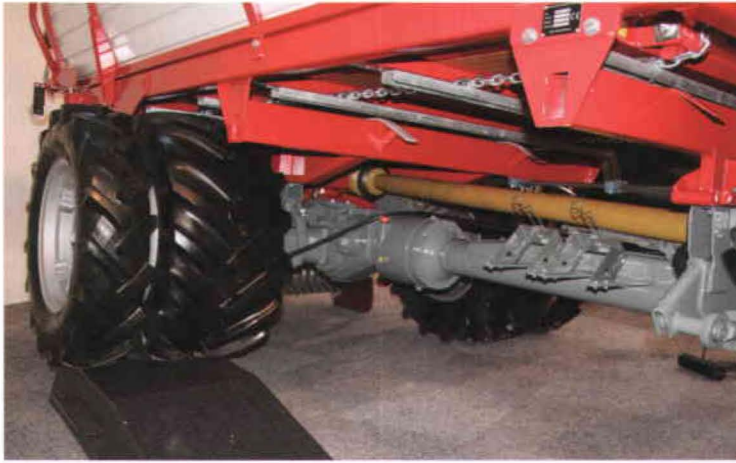
Figura 4.- Efecto del bastidor oscilante
