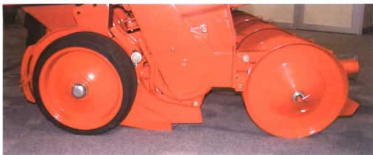
Surcador combinado de disco doble y azadón.
