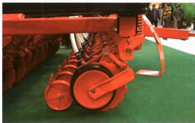
Bota de siembra con disco y rueda de apoyo
