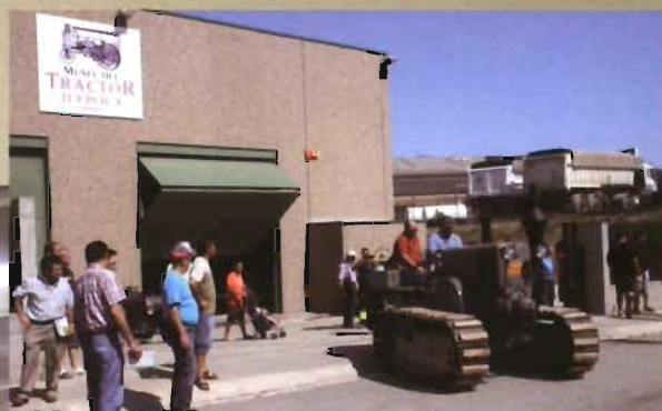
Lanz Raupen-Bulldog modelo D-1561, de 1942, con motor de un cilindro dos tiempos diésel de 10 338 cm 3 ; se pone en marcha calentando la culata con fuego.
