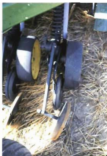
Surcador con disco en ángulo y rueda de apoyo.
