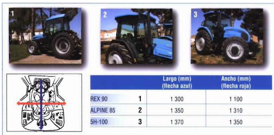
FIGURA 2. Medidas del interior de la cabina de los distintos modelos de tractor
