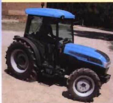
Con la rueda 13.6R36 el 5H puede estrecharse por debajo del 1,80 m.
