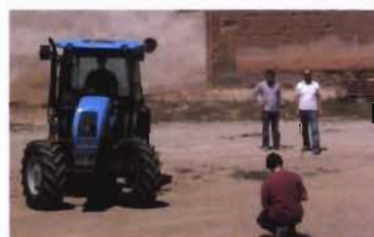
Recogida de datos para obtener el radio de giro del 5H-110 (imagen superior), del Alpine 85 (inferior izquierda) y del Rex 90.
