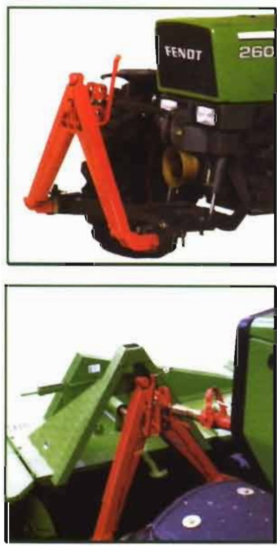
FIGURA 7.- ENGANCHE FRONTAL CON ACOPLAMIENTO RÁPIDO TIPO A
