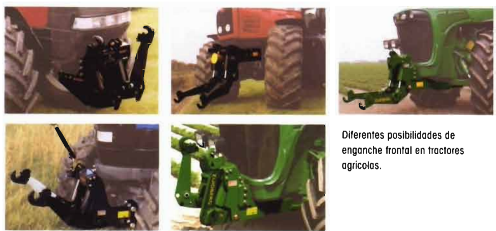
FIGURA 7.- ENGANCHE FRONTAL CON ACOPLAMIENTO RÁPIDO TIPO A
